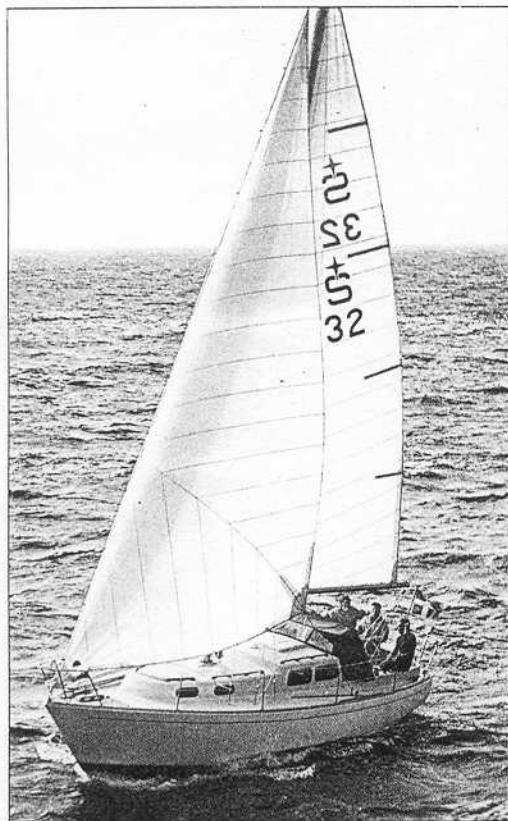
Singoalla var en ganska stor båt med Albin-mått mätt. Dryga 10 m lång, 45 kvm segel.
