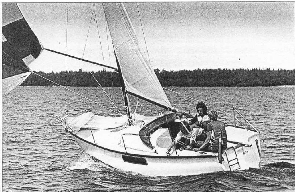
Albin 57 fick en trög start trots att idén var god. Med upphissad sänkköl kom man in i grunda vikar, samtidigt som båten också var trailerbar.
