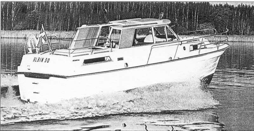
Hösten -72 var man färdiga med prototypen till Albin 30. Den var utrustad med dubbla VP MD21. Båten kom inte i produktion förrän 1976, då med en motor.
